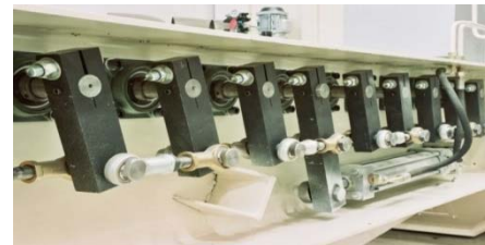
DESCARGA POR LAMAS BASCULANTES SISTEMA HIDRAULICO
